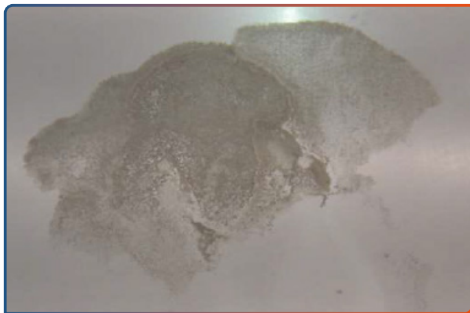
Imagem orientativa Exemplo de material apresentando oxidação branca
